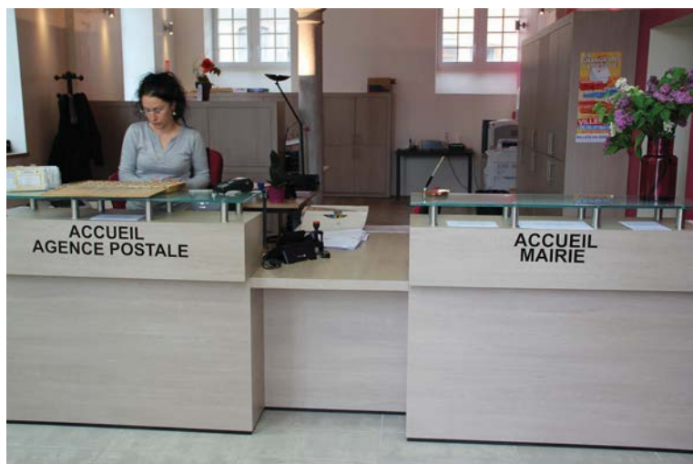
Aménagement d'une double banque pour l'accueil de la mairie (à droite), et de la Poste (à gauche), face à la porte d'entrée, avec une partie surbaissée au centre (Villebois)
