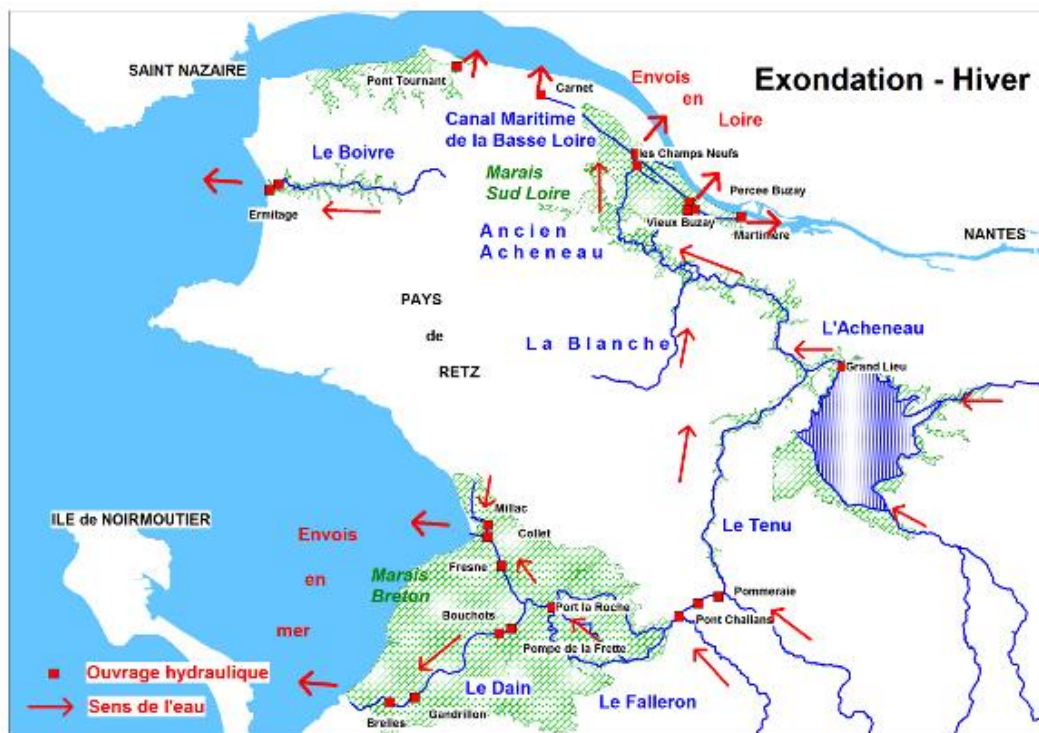
Figure 30 : système de gestion hydraulique du marais (source : SAH Sud Loire)
